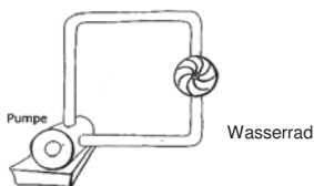
Abb. 2.11: Wassermodell für einen einfachen Stromkreis (schematische Darstellung)
